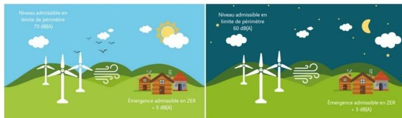
**Légende :** Zones à Emergence Réglementée (ZER) désignent, de façon simplifiée, les zones habitées potentiellement exposées aux niveaux sonores du parc éolien
